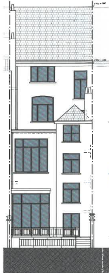
Elévation Arrière Situation Existante
