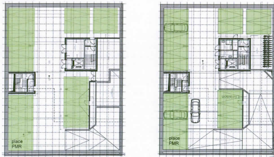
Figure 59 : Organisation des niveaux de parking (Source : A&B 2018)
