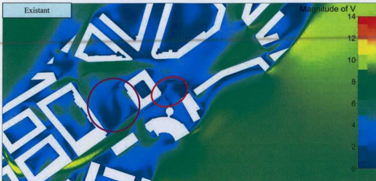
Figure 10 : Magnitude de vitesse à 1.75 m du sol – situation existante – direction de vent SSO
