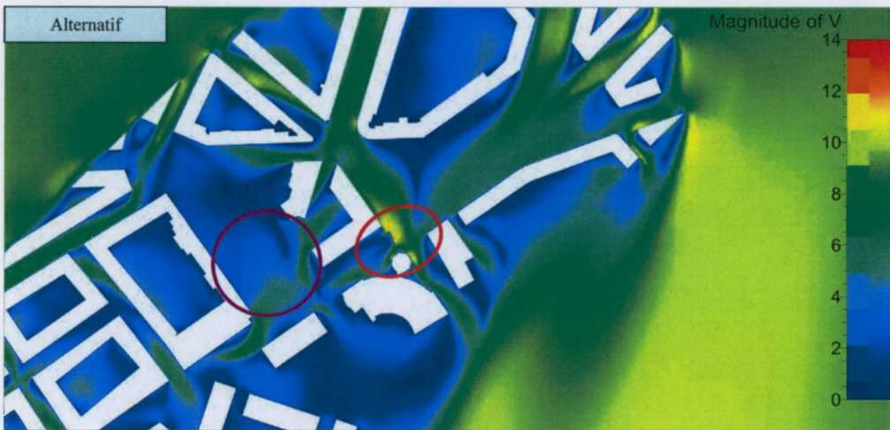
Figure 13 : Magnitude de vitesse à 1.75 m du sol – situation projetée – direction de vent NNE
