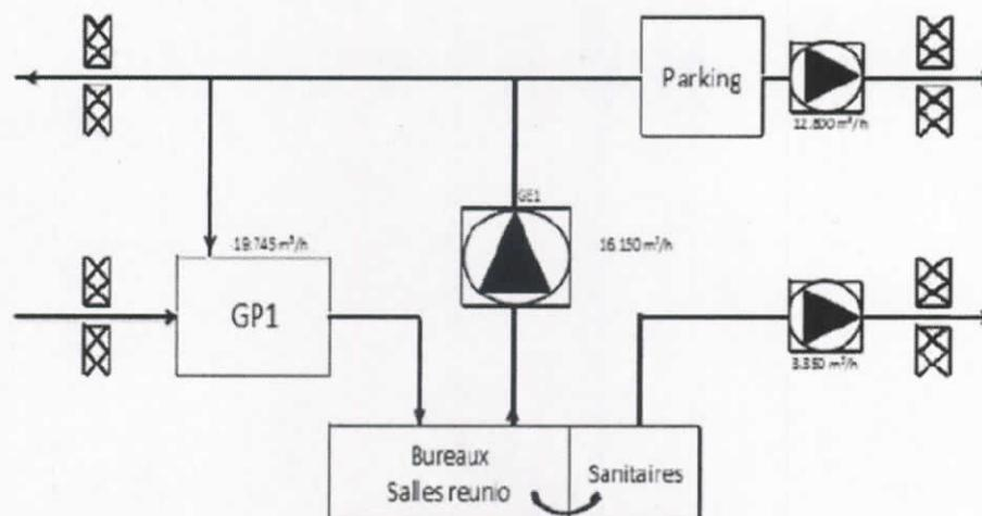
L'air vicié des parkings s'extrait via une tourelle d'extraction de référence 09J001VGE001 qui se trouve en toiture ; Le débit d'extraction de l'air du parking vers l'extérieur est de  $\pm 12.800 \text{ m}^3/\text{h}$ .
